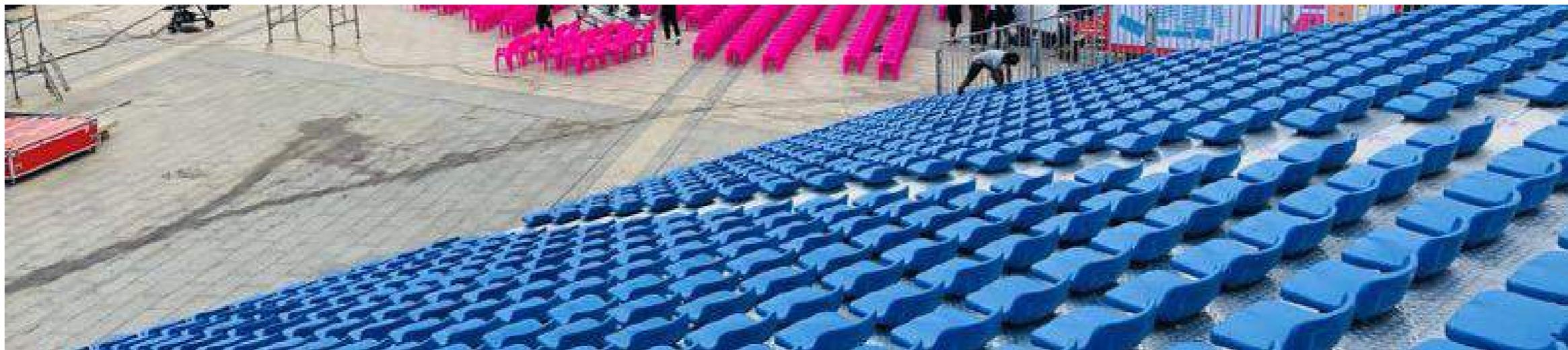
模块看台护栏满足体育设计规范要求，其抗冲击参数远超出疏散的安全系数要求。看台踏板采用抗腐蚀的镀锌板材，消除了材料腐蚀引起安全系数下降的可能。
